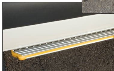
Trittstufe bei der Schiebetüre mit elektrischem Antrieb, Steuerung über Kontaktschalter
