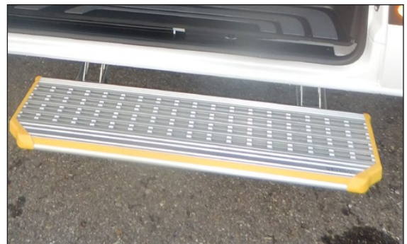
Trittstufe bei der Schiebetüre mit elektrischem Antrieb. Steuerung über Kontaktschalter.
